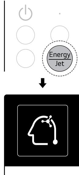
3 Wenn der Heizbetrieb beginnt, drücken Sie wiederholt die Taste **Energy/Jet**, um den **Smart Care**-Betrieb zu wählen. Das Symbol für den **Smart Care**-Betrieb erscheint, und der Kühlbetrieb im **Smart Care**-Betrieb beginnt.
