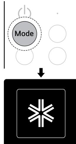
**3** Wenn der Kühlbetrieb beginnt, drücken Sie die Taste **Comfort**. **Indirect On** erscheint, und aus dem Luftauslass an der Unterseite des Geräts tritt keine Luft aus.
